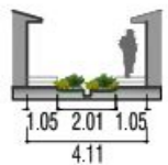
CORTE 49-49 PASAJE JOSÉ OLAYA VIA PAVIMENTADA 4.11 ml
